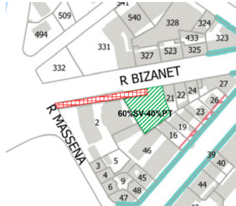
Plan provisoire Création d'une marge de recul et d'une variation des surfaces végétalisées
